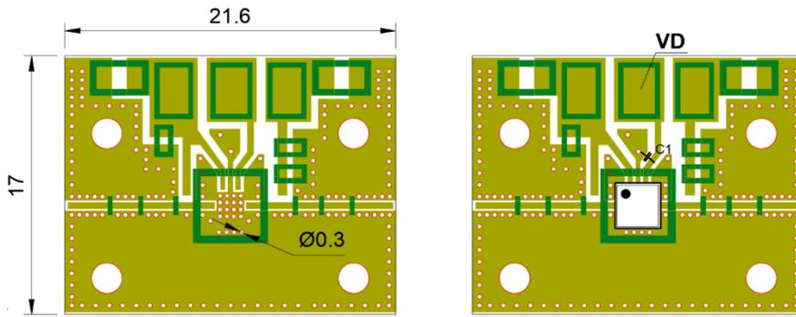
评估板板材为 Ro4350b, 介质厚度 0.254mm, 输入与输出传输线设计阻抗为 50Ω
