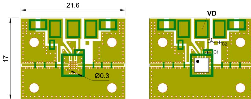
评估板板材为 Ro4350b, 介质厚度 0.254mm, 输入与输出传输线设计阻抗为 50Ω
