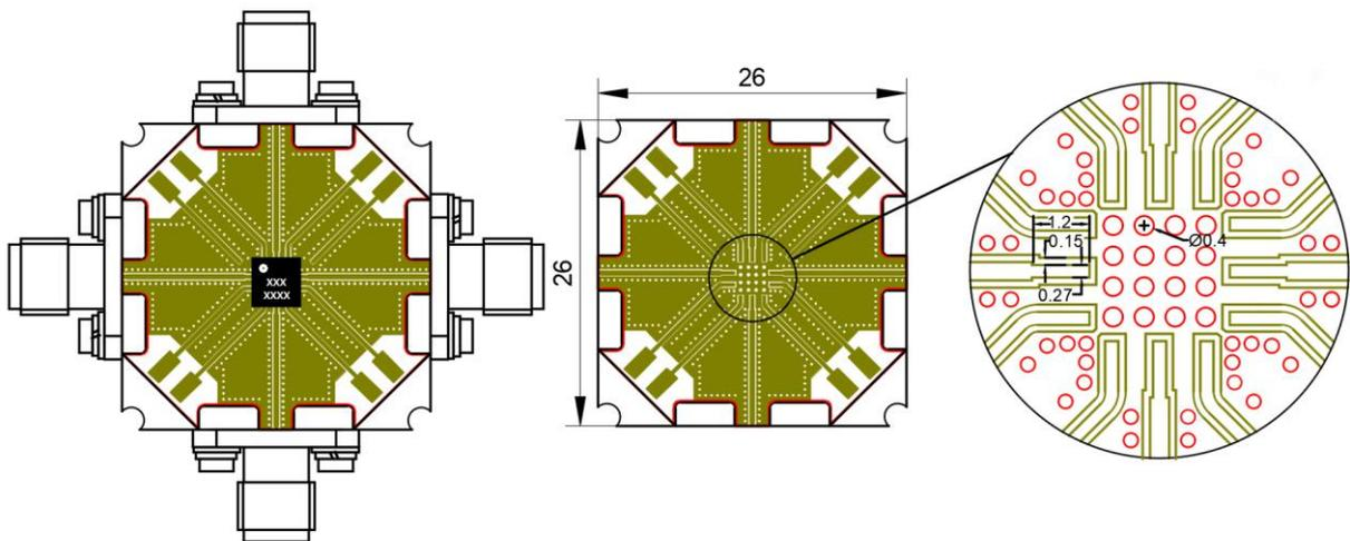
板材 Ro4350b, 介质厚度 0.254mm, 输入与输出传输线设计阻抗为 50 Ω
